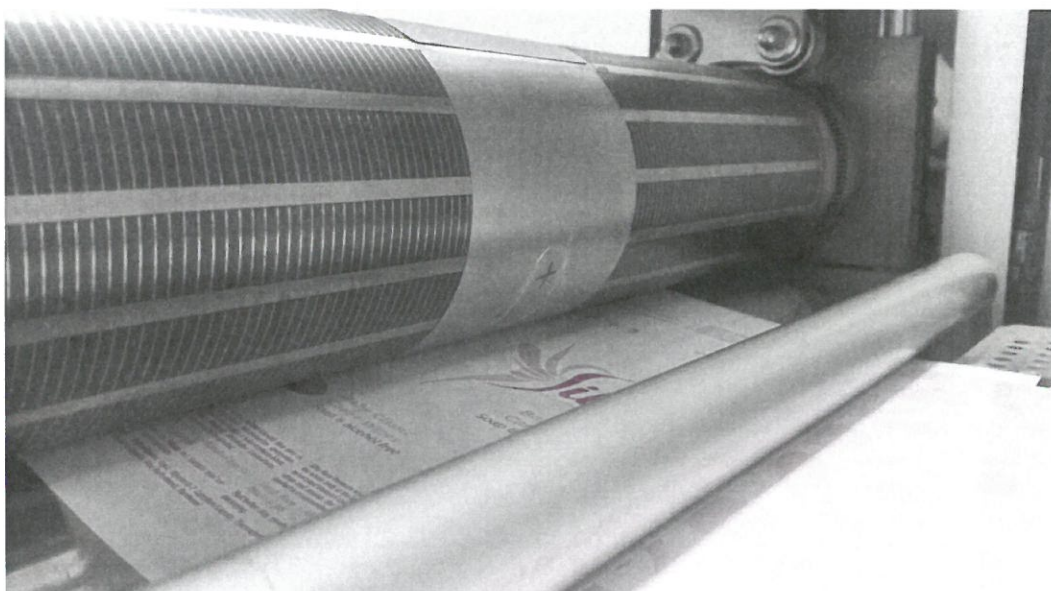
Mágneses henger felszerelve a moduláris szerzőrámmal.
