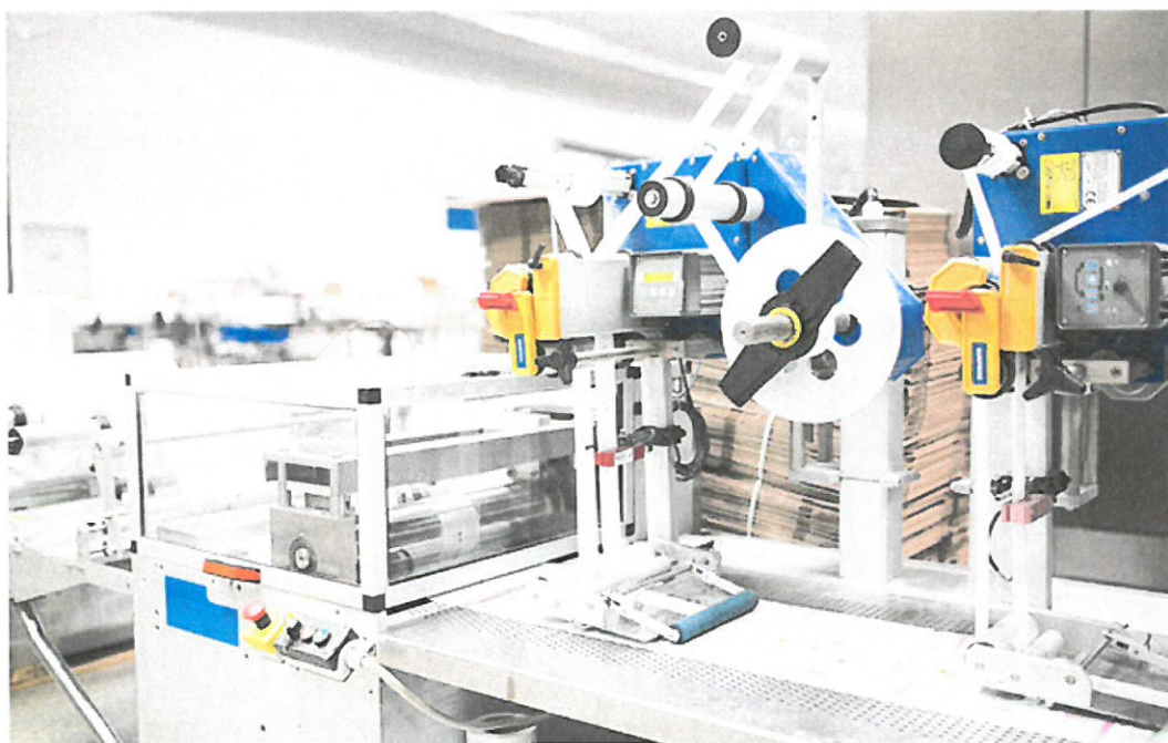
Az új mágneses hengerrendszer integrálása a gyártósorban. Baloldalon látható a mágneses henger, középen rajta a kivágó szerszámmal.
